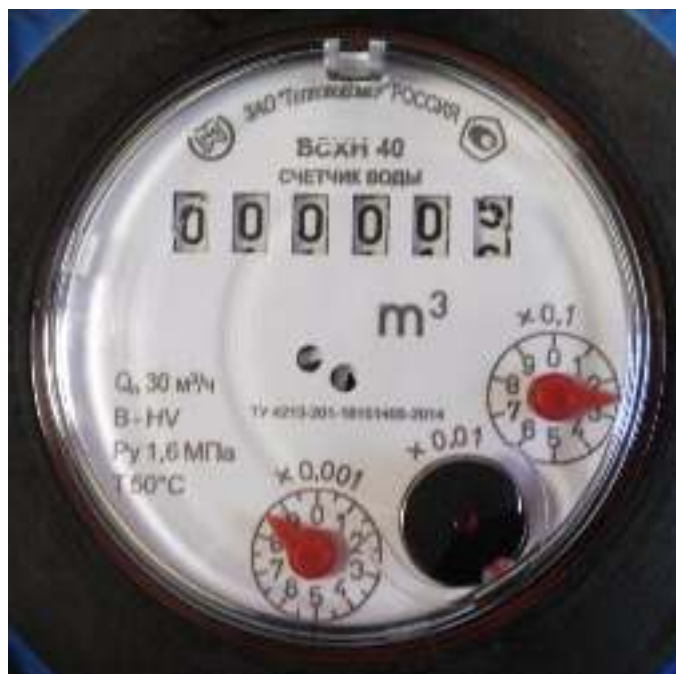
Рисунок 1. Пример снятия показаний со счётчика воды.
